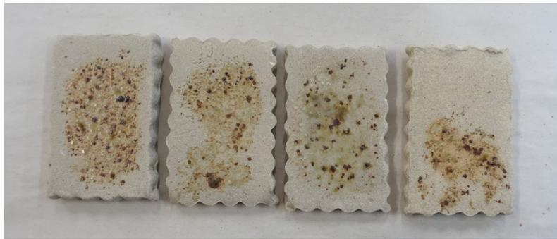
///Tests des quatre types de cendres pures, cuisson à 1280°
